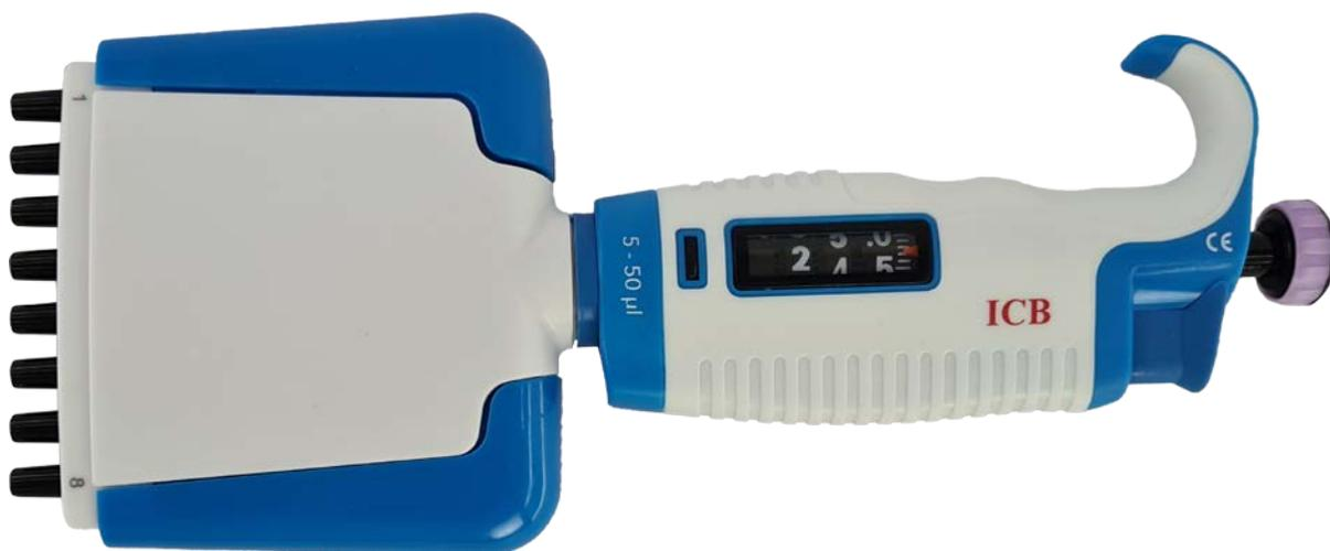
Las pipetas se ajustan continuamente para muestrear y dispensar líquidos de forma precisa. Su uso se basa en el principio de desplazamiento de aire (ejemplo: una interfaz de aire se encuentra presente entre el pistón y el líquido) y utiliza puntas desechables. El volumen deseado se determina de acuerdo a la siguiente fórmula:
